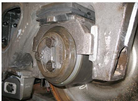
Conjunto de rodadura de un vehículo ferroviario
