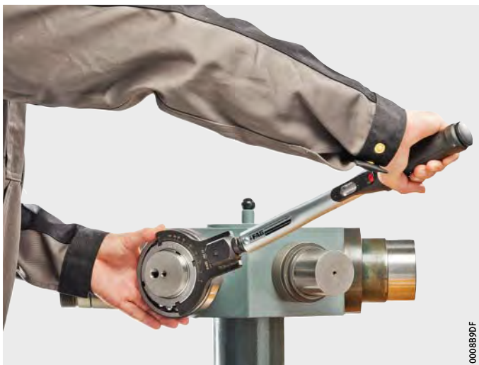
Figura 11 Montaje mediante llaves de doble gancho
