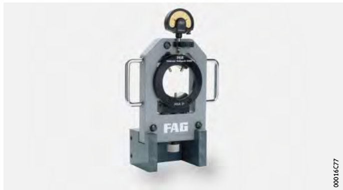
Figura 10 Instrumento de medición del círculo límite FAG MGI 31
