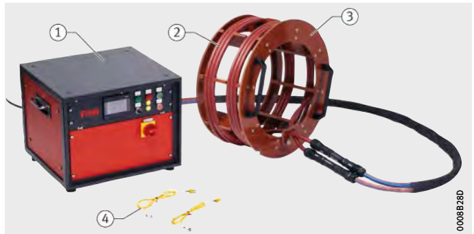
Figura 18 Dispositivo de calentamiento de media frecuencia FAG
