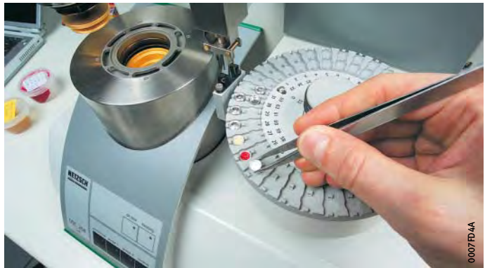
Figura 5 Análisis del comportamiento térmico de las grasas
