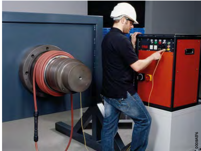
Figura 10 Desmontaje de anillos interiores mediante inductores flexibles
