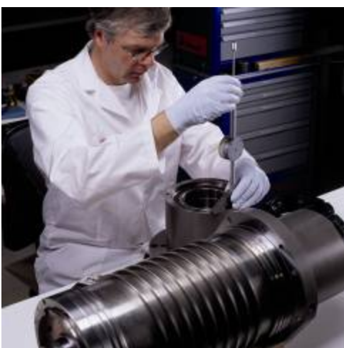
Montaje de rodamientos para husillos
