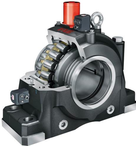
Los soportes de apoyo SNS de FAG son indicados para el montaje de rodamientos de diámetros y anchuras diferentes. Los rodamientos son desplazables, con lo cual actúan como rodamientos libres.
