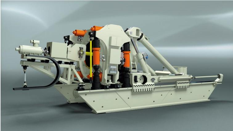
Mediante el banco de ensayo para grandes rodamientos ASTRAIOS, Schaeffler ofrece unas posibilidades únicas de ensayo, sobre todo para rodamientos de rotor y coronas giratorias con un diámetro exterior de hasta 3,5 metros.
