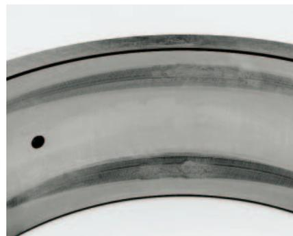
Daños por deslizamiento en el rodillo de un rodamiento oscilante de rodillos, montado en un cilindro aspirador. Causa: carga muy reducida y grasa lubricante no apropiada
