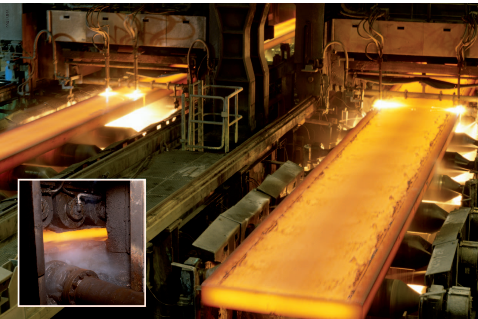
Figura 1 · Rodillos en coladas continuas CGM 22
