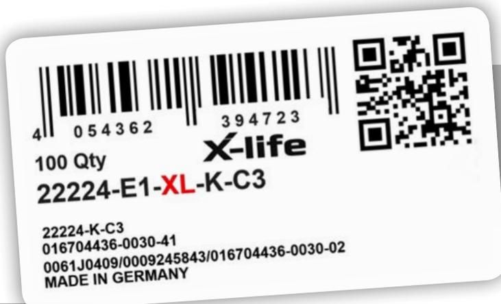
Ejemplo de la nueva descripción de producto X-life: etiqueta identificativa del embalaje de un rodamiento oscilante de rodillos.
