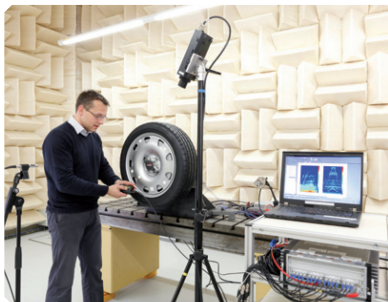
Análisis de aislamiento acústico y comportamiento vibratorio en el rodamiento de un neumático de coche en una sala anecoica.
