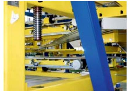
Sistema de accionamiento de brazo giratorio y sistema de guiado de la chapa, para girar 90° y posicionar las chapas del sentido longitudinal al sentido transversal con la ayuda de un módulo tándem MDKUSE-25 de INA
