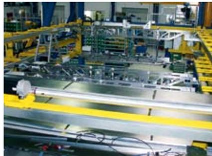
Vista interior del sistema de manipulación y posicionamiento de chapas metálicas para núcleos de transformador de Tuboly-Astronic, AG, que incluye un total de nueve módulos lineales y módulos tándem de INA
