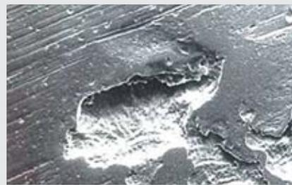
Micro desprendimientos (imagen del microscopio electrónico de barrido (SEM))
