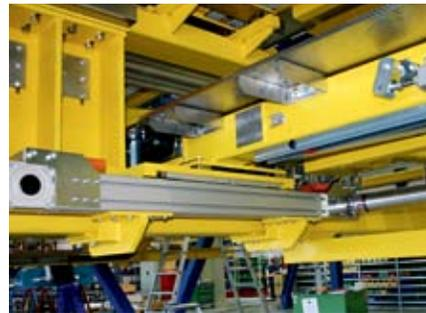
Unidad de ajuste transversal del sistema de transporte lineal de chapas excéntricas con uno de los dos módulos lineales MKUSE-25 de INA
