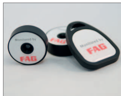
Tags RFID para la detección automática de los puntos de medición
