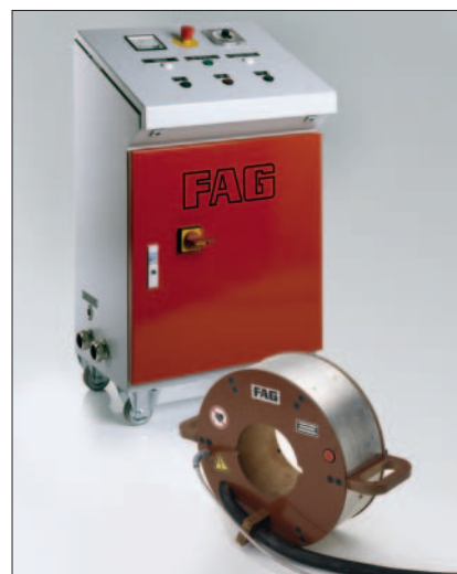
Bobina inductiva con armario, para tensión nominal, para desmontar aros interiores de rodamientos de rodillos cilíndricos
