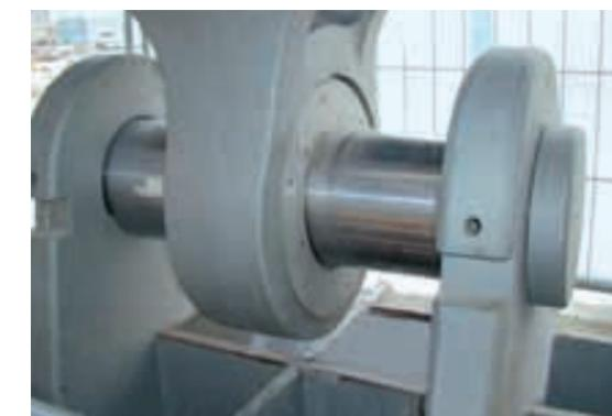
Calidad ELGES comprobada: los sistemas de apoyo están compuestos por rótulas de diseño especial, recubiertas de ELGOGLIDE®, y pernos/ejes
