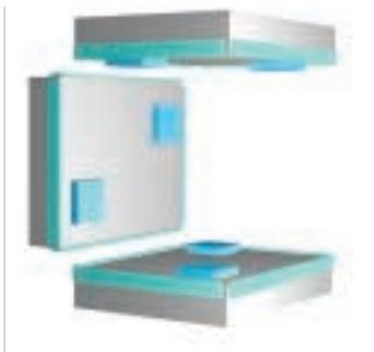
Con los sistemas de motores planos, la fuerza es producida mediante el principio de reluctancia.
