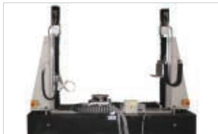
Rodamiento aerostático en sistema de ejes para la industria óptica
