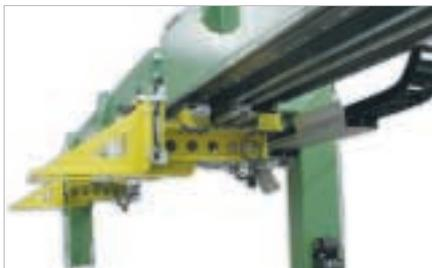
Eje lineal de alta velocidad para manipuladores y automatismos
